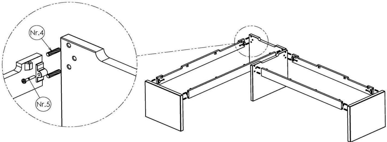
Verwenden Sie hierzu eine Innenwange (Nr.11) und eine Außenwange (Nr.9). Stecken Sie acht Dübel (Nr.4) in die äußeren Bohrungen. Verbinden Sie jetzt zwei Querstreben (Nr.10) mit den Wangen. Dabei ist darauf zu achten, dass die Querstrebe mit den Ausschnitten an die hintere Seite montiert wird.
